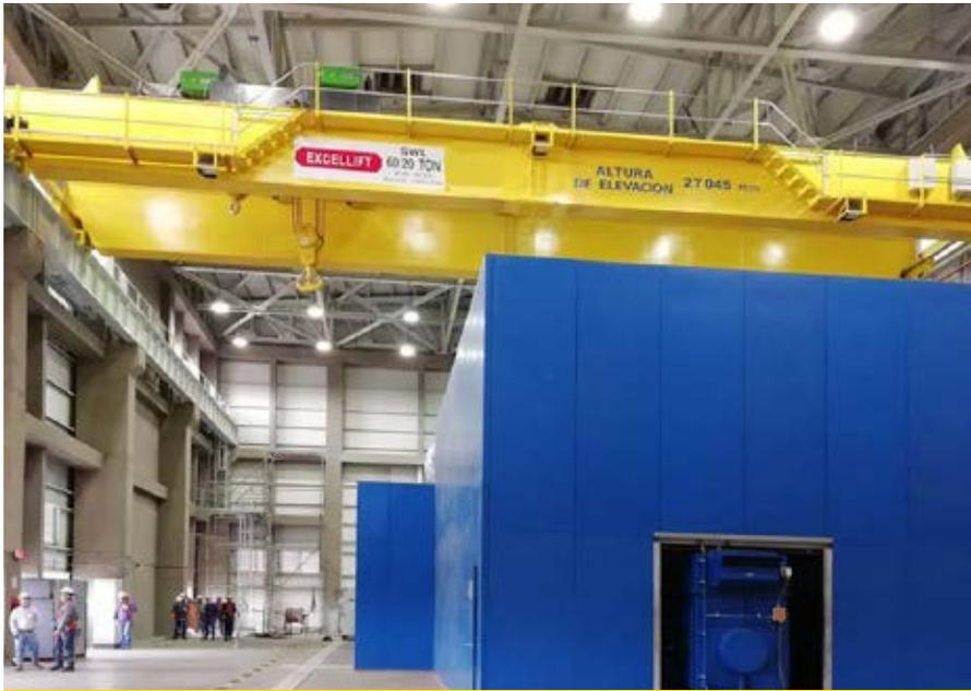
Der STAHL CraneSystems-Partner EXCELLIFT aus Malaysia liefert Krananlagen nicht nur nach Südost- und Zentralasien, sondern auch bis nach Südamerika aus. Im Mai 2018 installierte EXCELLIFT in einem Kraftwerk in Kolumbien einen Zweiträgerbrückenkran mit einem AS 7 mit 60 Tonnen Tragfähigkeit. Als Hilfshub fungiert ein Seilzug SH mit einer Tragfähigkeit von 20 Tonnen.
