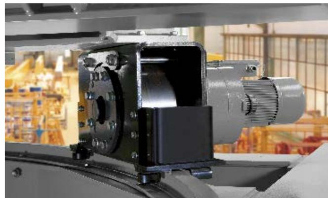
Die Stärke des Radblocks SR ist die kostengünstige Serienfertigung aus bewährten und wartungsarmen Standardkomponenten. Auf dieser Basis stehen sechs verschiedene Baugrößen für Radlasten zwischen 5.000 und 30.000 kg zur Verfügung. Ein wichtiges Merkmal des Radblocks SR ist die einfache Montage durch die drei standardisierten Anbaumöglichkeiten für Kopfanschluss, Schweißanschluss und Einsteckanschluss.
